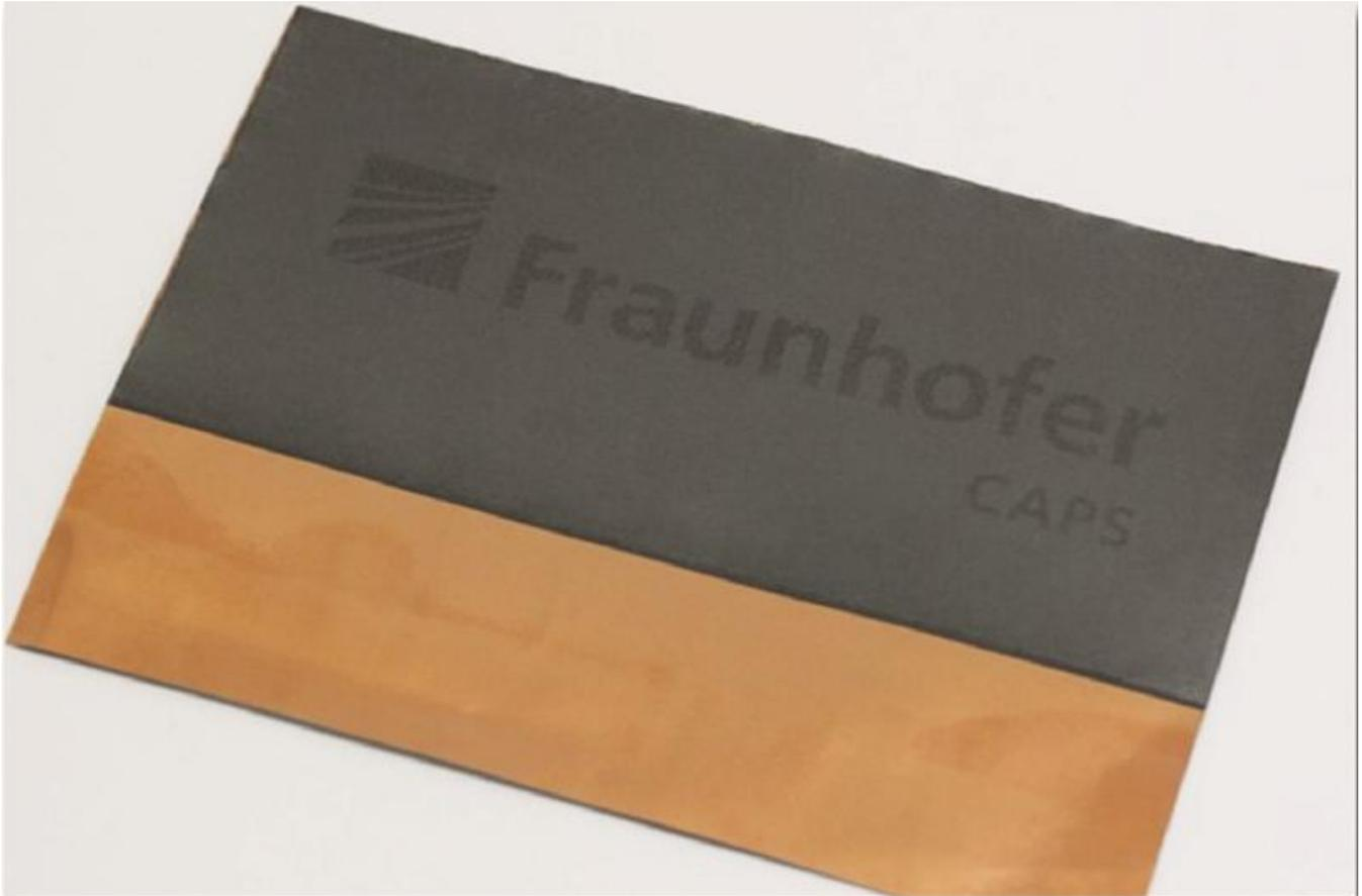
Laserstrukturiertes Anodenmaterial einer Li-Ionen-Batterie.
