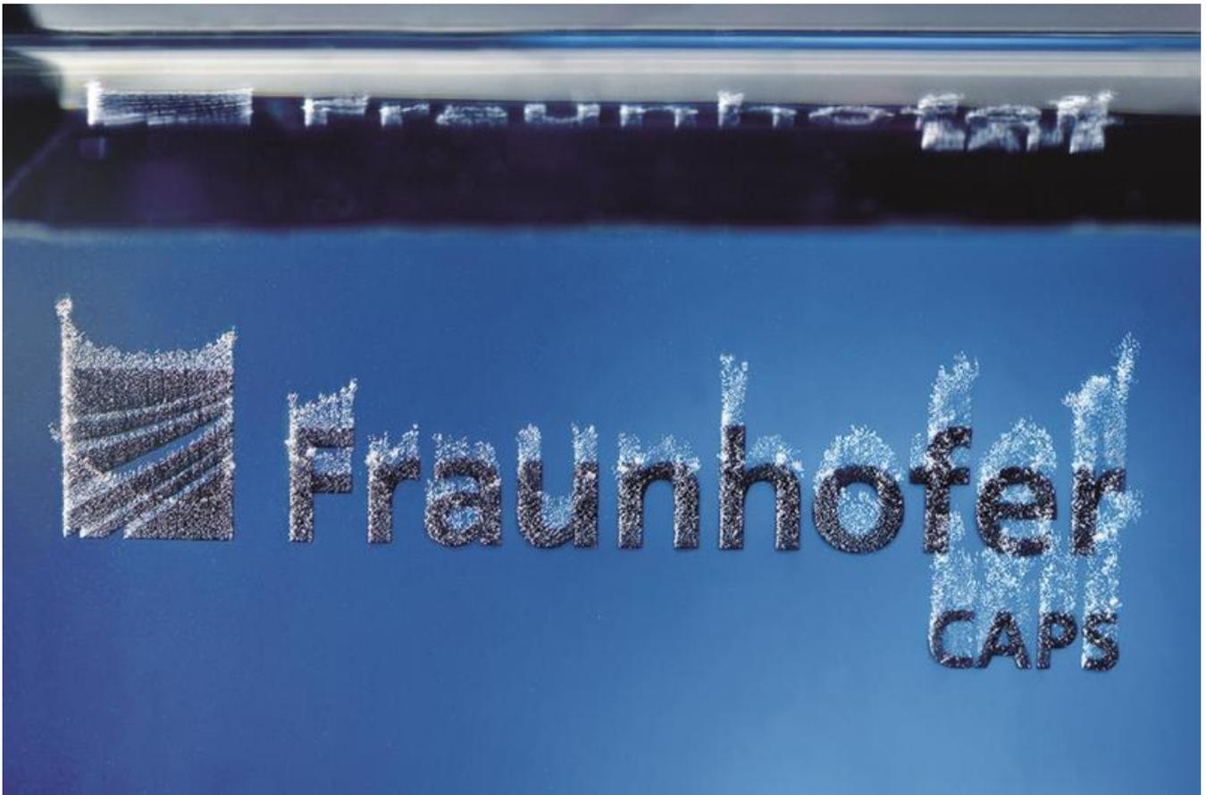
Großflächige UKP-Strukturierung in CAPS-User Facility: Wasserstoffentwicklung an Metallelektroden.
