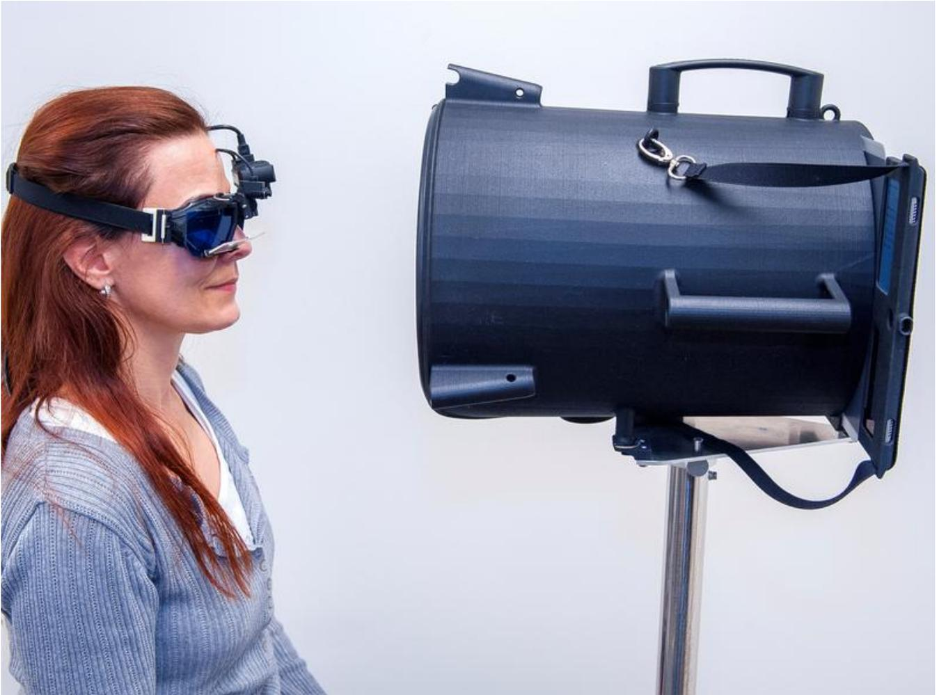
Vorrichtung bei der Entwicklung des neuen Tests: Eine Videobrille, ein umgebauter Papierkorb und ein Tablet reichen technologisch vollständig aus.
