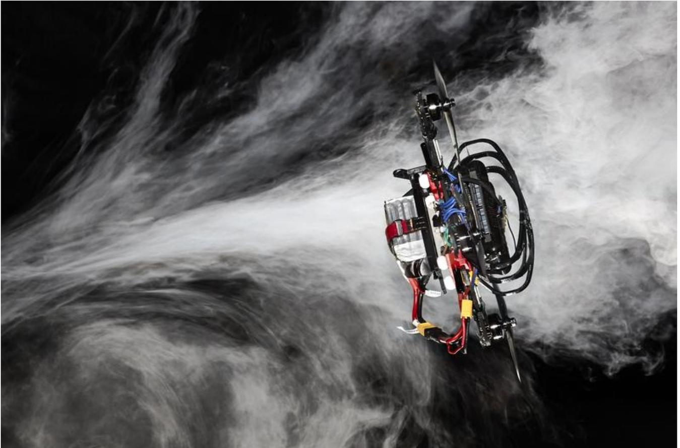
Eine Drohne fliegt durch Rauch, um die komplexen aerodynamischen Effekte zu visualisieren.
