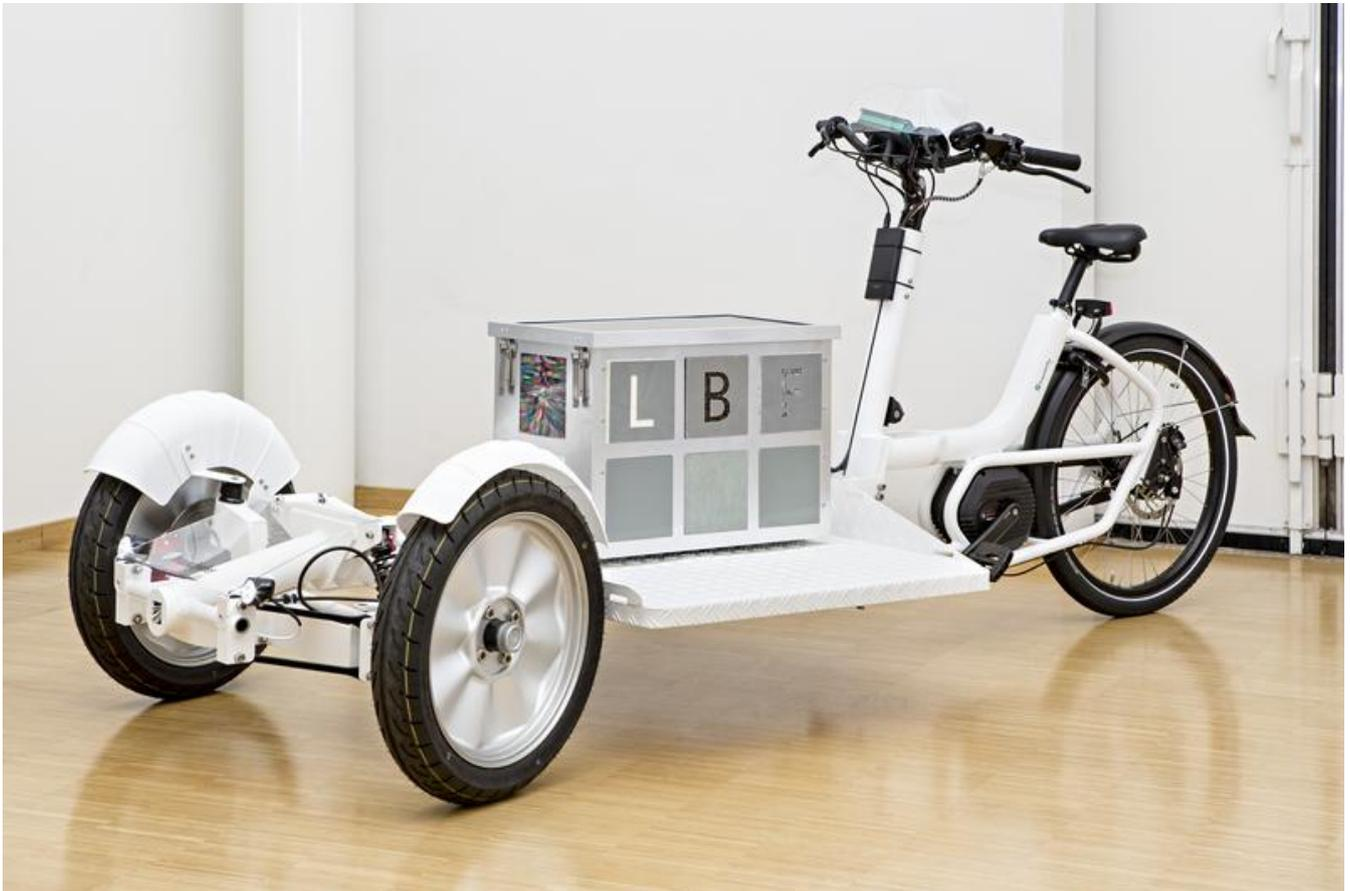
Leicht, intelligent, zuverlässig: Das »Lasten-LeichtBauFahrrad« (L-LBF) zeigt das Potenzial des funktionsintegrierten Leichtbaus für die Mobilität
