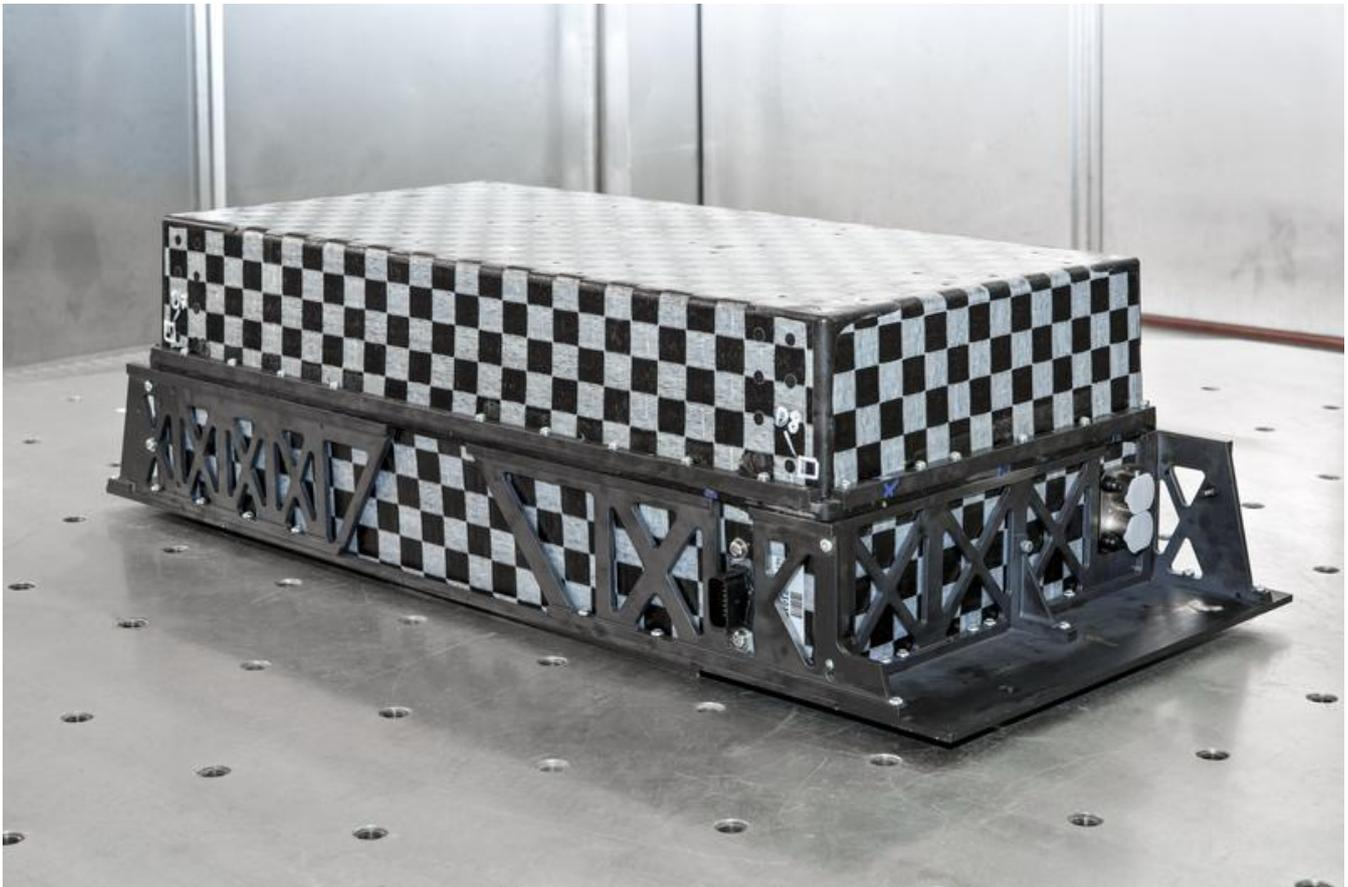
Leicht, nachhaltig, sicher und effizient: Das Batteriegehäuse aus einem Polymerschaukern und endlosfaserverstärkten Thermoplasten (CFRTP) ist innerhalb von nur zwei Minuten hergestellt und das ohne Nachbearbeitung.
