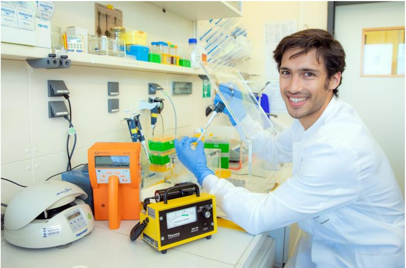
Dr. Simon Krooss beim Pipettieren im Labor an einem mit Geigerzählern ausgestatteten Radioaktivarbeitsplatz. Mit Hilfe der radioaktiven Marker lässt sich die Expression von Genen in den Proben nachvollziehen.
