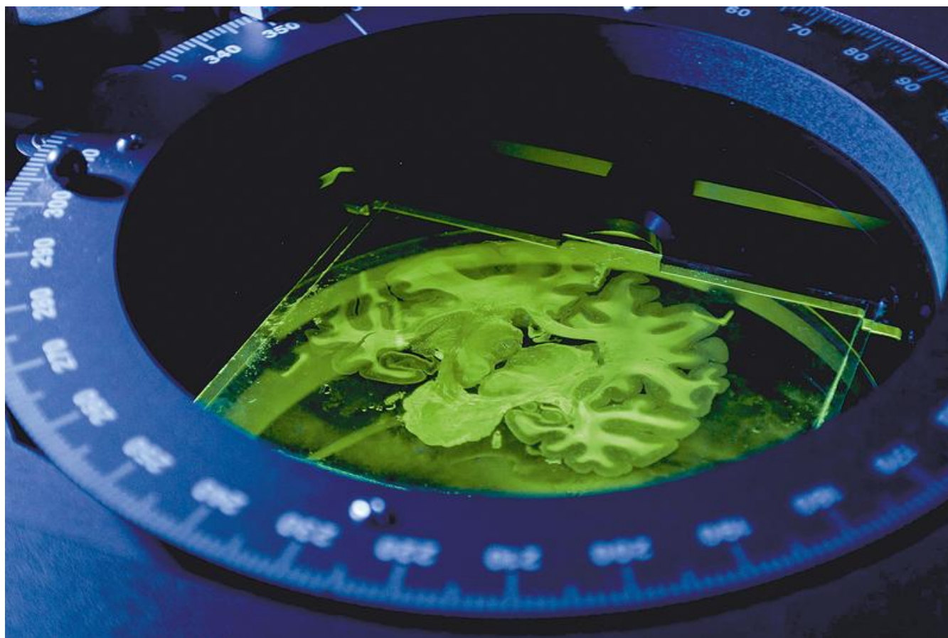
Hochauflösende Untersuchung eines Hirnschnitts mittels 3D Polarized Light Imaging (3D-PLI) Forschungszentrum Jülich Forschungszentrum Jülich
