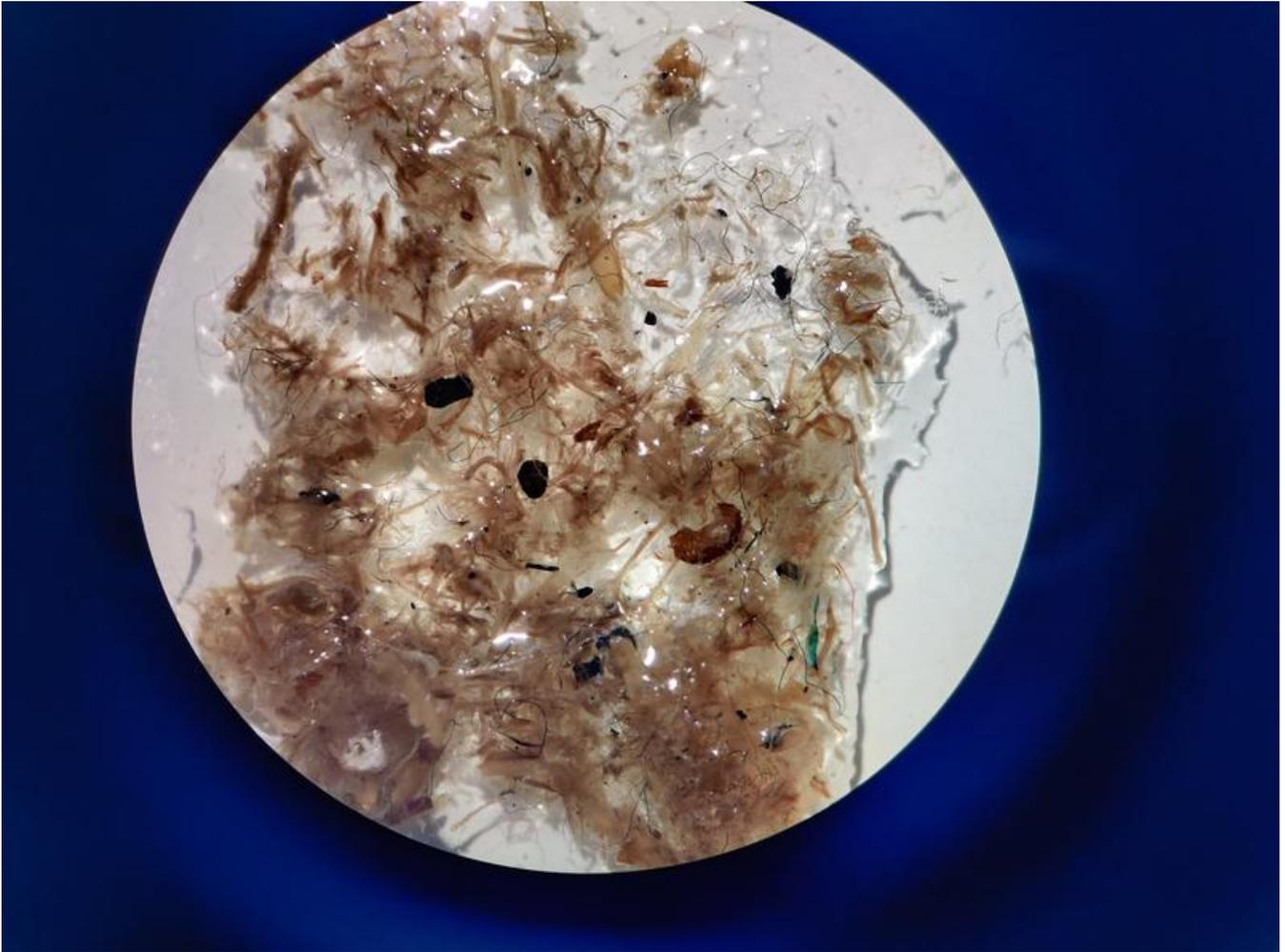
Verdächtige Mikroplastik-Fasern  $> 500 \mu\text{m}$  aus einem mit Klärschlamm behandelten Boden. Man erkennt zwischen Pflanzenmaterial künstliche Fasern. Diese werden extrahiert und mithilfe von FT-IR bestimmt.
