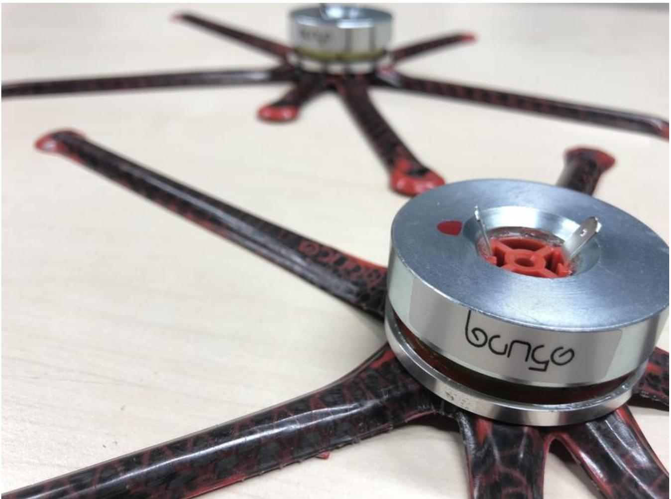
Forscher der Universität Stuttgart haben die Bauweise eines gehäuselosen Lautsprechers verbessert und ein neuartiges Feder-element entwickelt, mit dem der Exciter ohne Kühlung auskommen kann.
