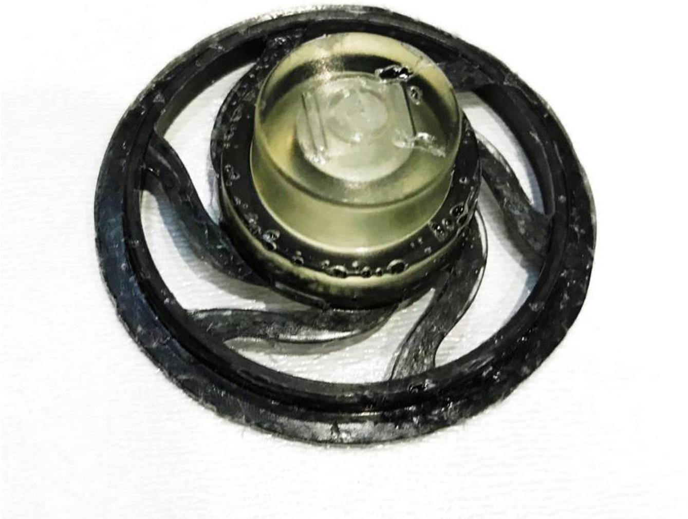
Das Federelement für den Exciter besteht aus endlosfaserverstärkten Kunststoffen, die wärmeleitfähig sind.
