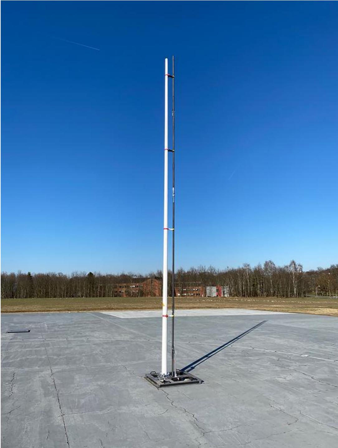
Auf dem Antennenfreifeld der PTB: Der schwarze Stab ist eine originalgroße Kopie eines der zwei Ausleger der Radarantenne für die Raumsonde JUICE (der weiße Fahnenmast dient lediglich als Support)
