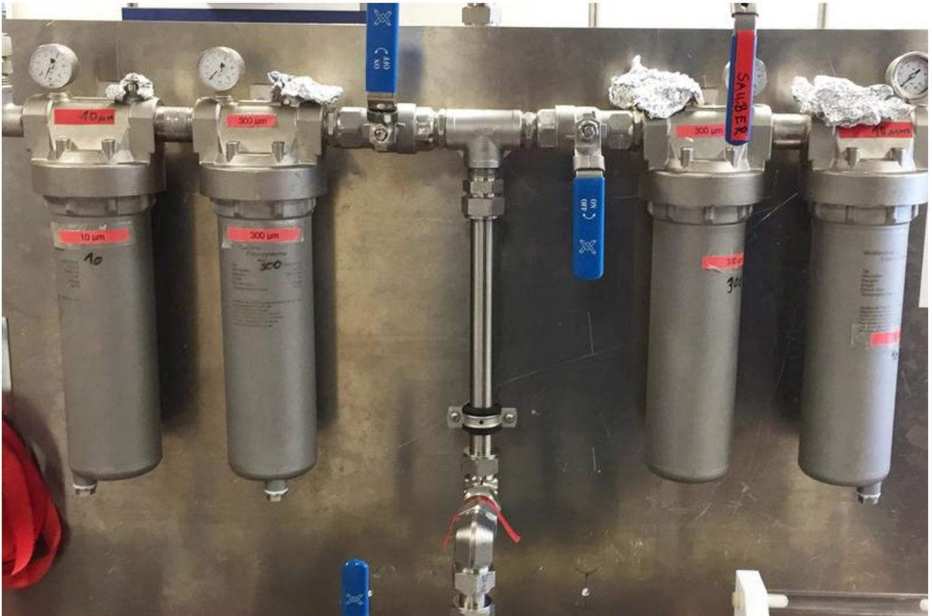
Dank der Filtrationseinheit ist die Messung der Mikroplastikpartikel exakter geworden. Foto: Hereon/ Fadi El Gareb
