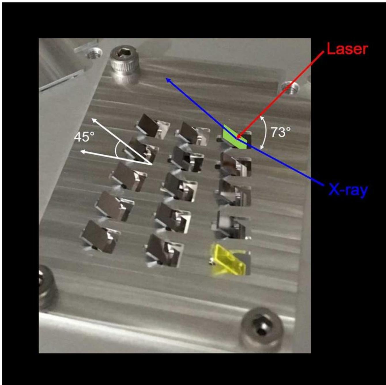
Im Experiment verwendete mehrschichtige Proben. Jede Probe hat eine Größe von 4 x 7 mm. Nach jeder Laserbestrahlung wird eine neue Probe verwendet.
