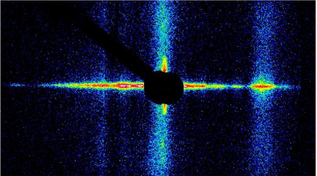
Röntgenkleinwinkelstreuung unter streifendem Einfall an einer mehrschichtigen Probe, gemessen mit einzelnen Röntgenpulsen des SACLA-Röntgenlasers in Japan.
