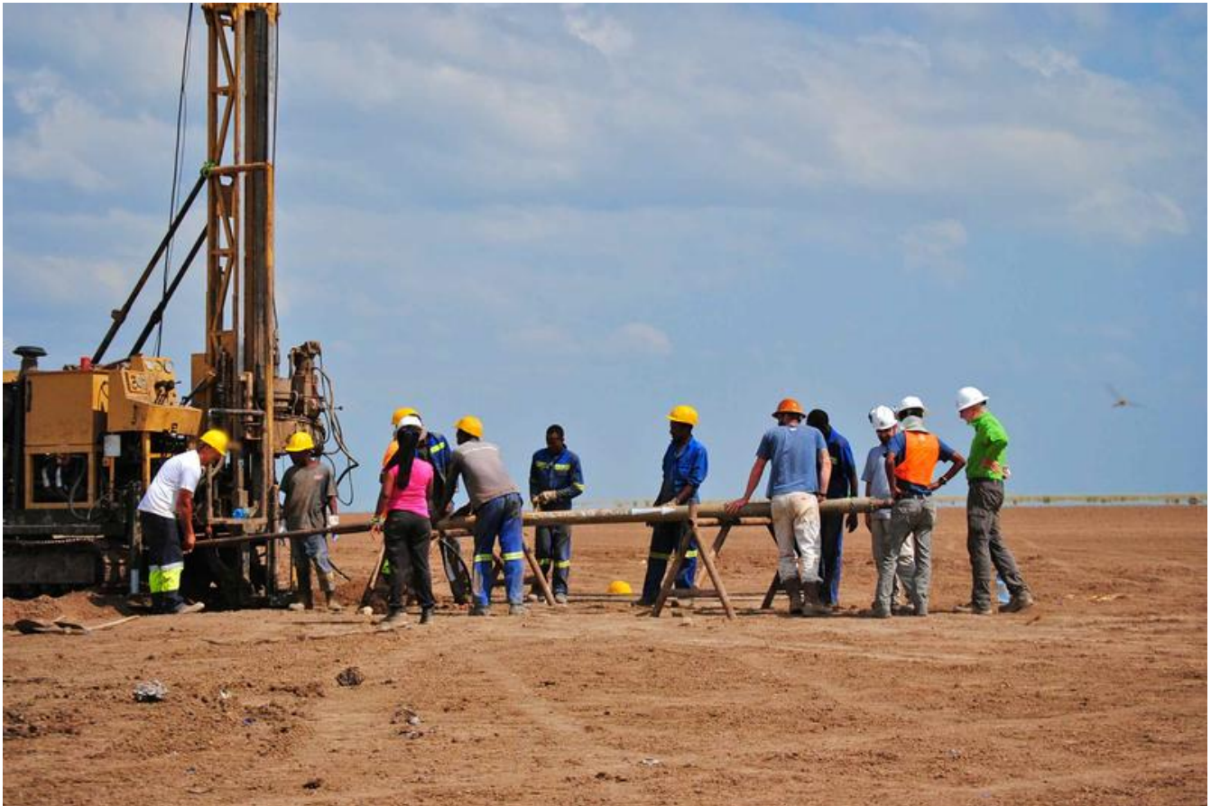
Chew Bahir, Entnahme eines mit Sedimentmaterial gefüllten Liners aus der Bohrkammer: die Tagesschicht versucht, den Liner mit vereinten Kräften herauszuziehen Frank Schaebitz Frank Schaebitz
