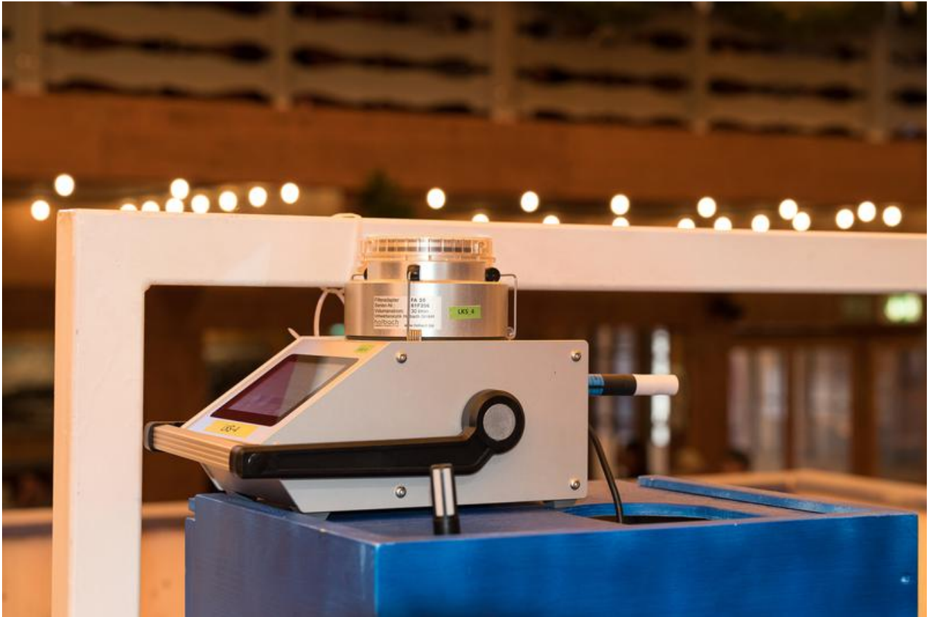
Der blaue Kasten hat es in sich: Hier wurden die Luftproben im Festzelt zum Nachweis der Luftkeime genommen. Christian Scherer Fraunhofer IBP
