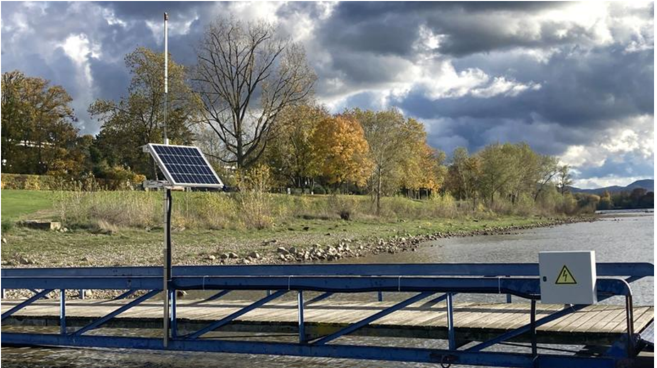
Der Wasserstands-Sensor lässt sich mit Solarzellen betreiben und arbeitet dann völlig autark und wartungsfrei. Foto: Makan Karegar/Uni Bonn
