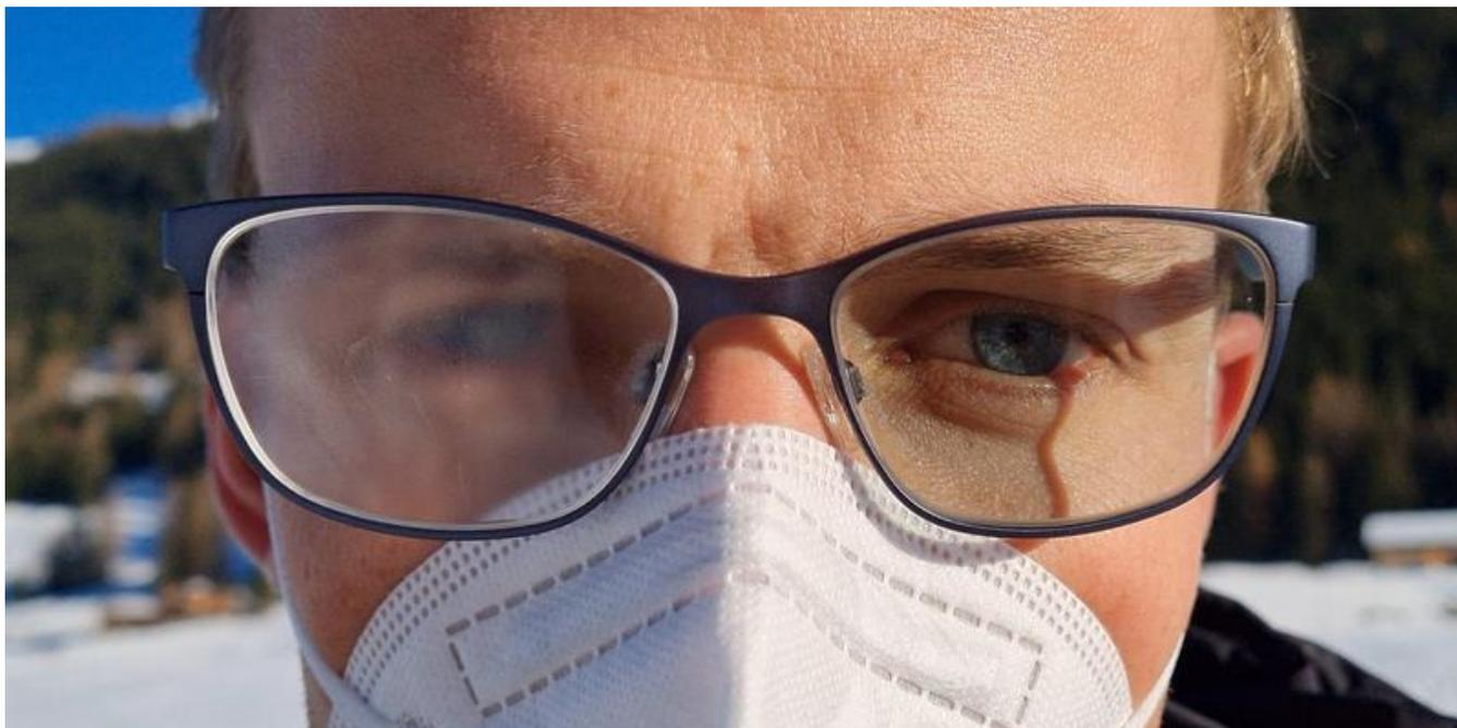
Gesichtsmasken können im Winter zu einer beschlagenen Brille führen. Bei dieser Brille trägt das linke Glas (vom Betrachter aus rechts) die neue Antibeschlags-Nanobeschichtung. Das rechte Glas ist unbeschichtet.
