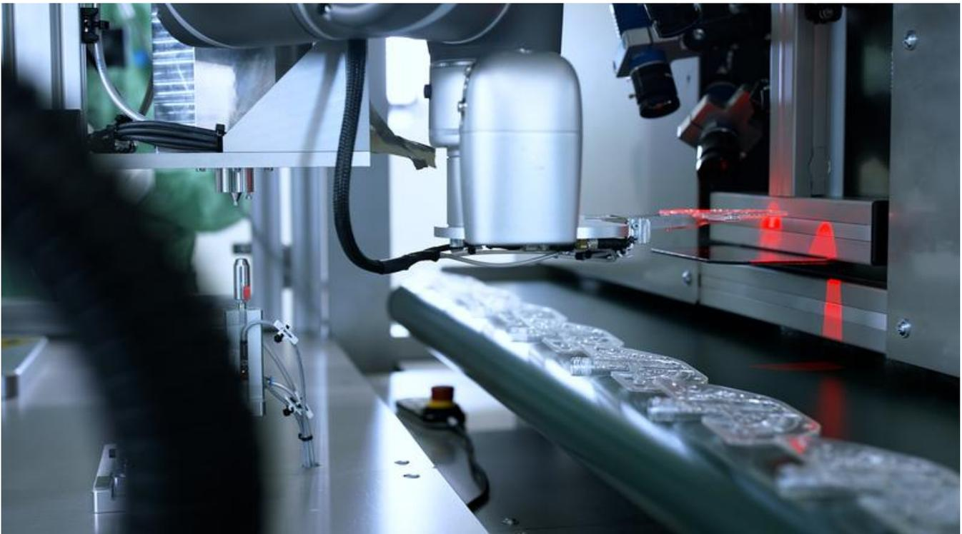
Mittels vollautomatischer Kameraprüfung werden die korrekte Befüllung und Bestückung der PCR-Testkartusche kontrolliert.
