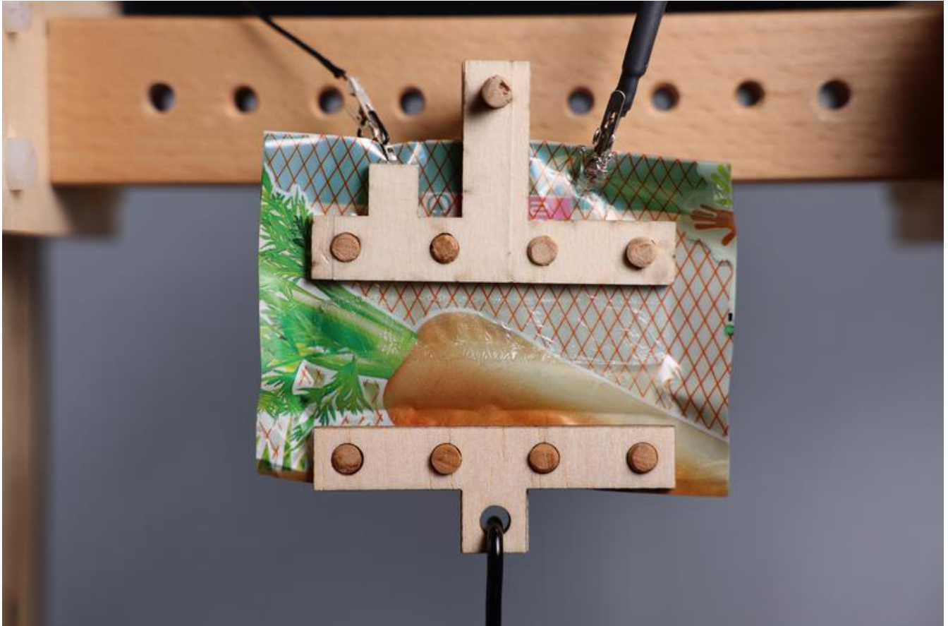
Ein Greifarm aus Biopolyester MPI-IS
