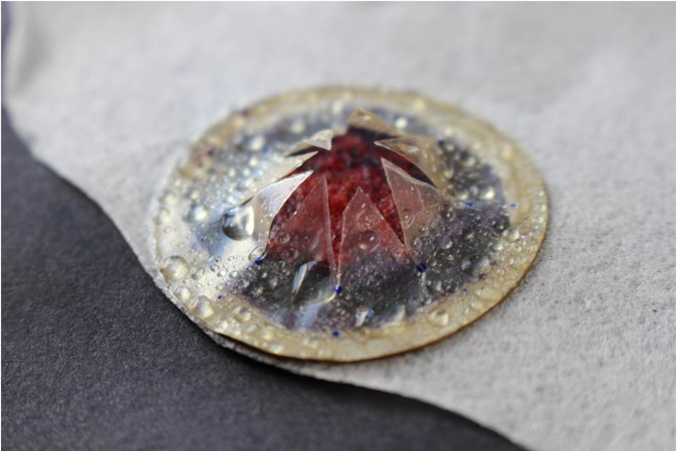
Sensor-Blüte: Der Schutzfilm aus Nanocellulose über dem Sensor öffnet sich wie eine Blüte, sobald er mit Feuchtigkeit in Berührung kommt – und der Sensor beginnt seine Arbeit. Empa
