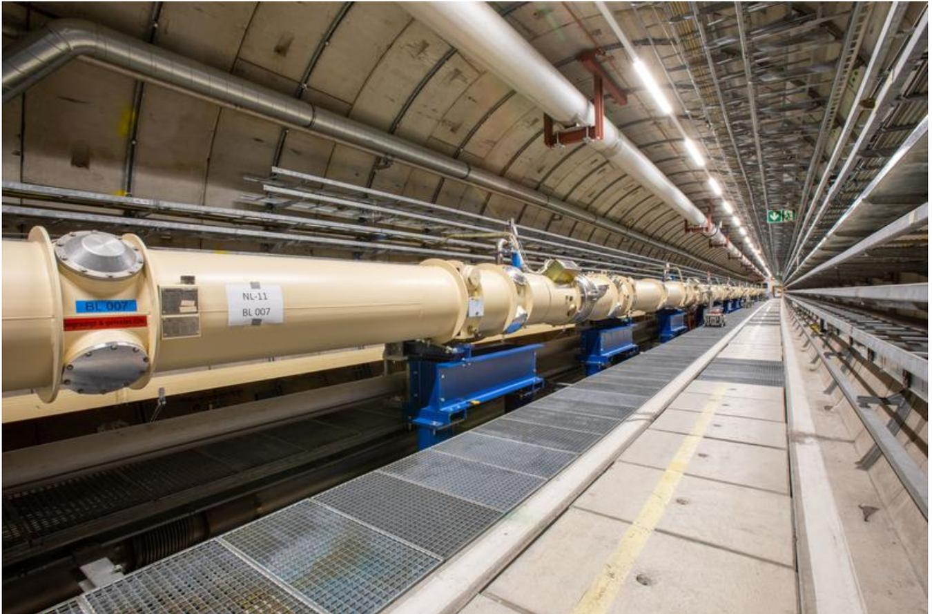
Magnetreihe des ALPS-Experiments im HERA-Tunnel: In dieser Hälfte der Magnete wird intensives Laserlicht hin- und hergespiegelt, aus dem sich Axionen formen sollen.
