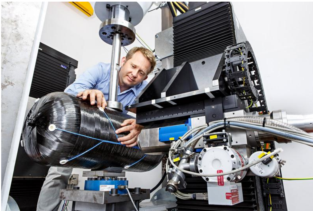
Der HyMon-Drucktank wird im Fraunhofer LBF vorgeschädigt. © Fraunhofer LBF/Ursule Raapke
