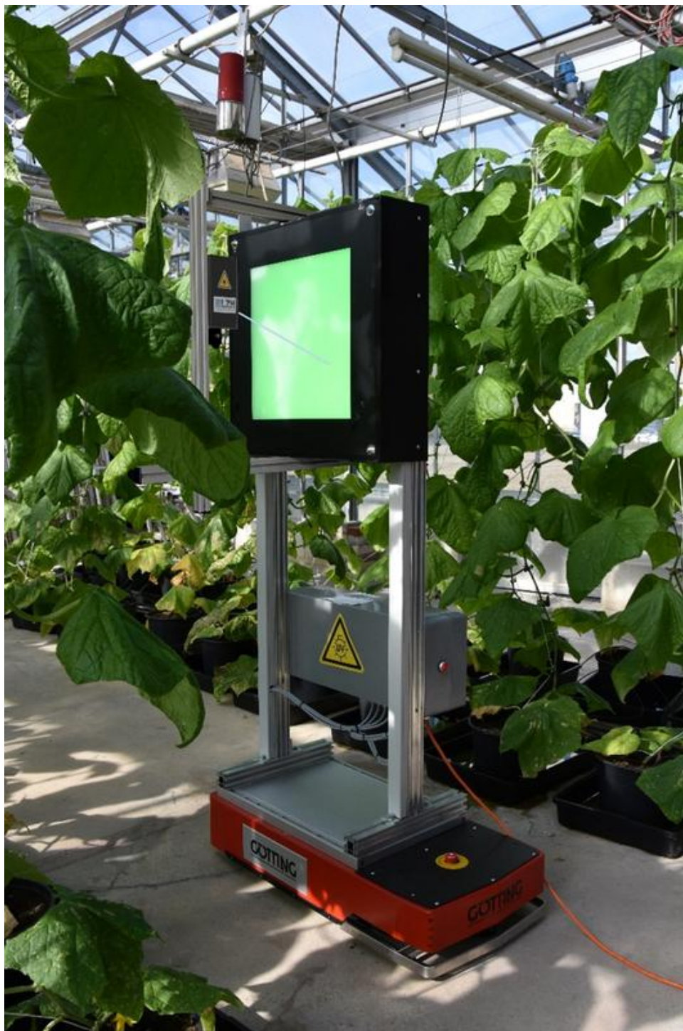
Mit der „LichtFalle“ setzt das LZH auf KI-gestützte Lasertechnik zur Schädlingsbekämpfung. Foto: LZH
