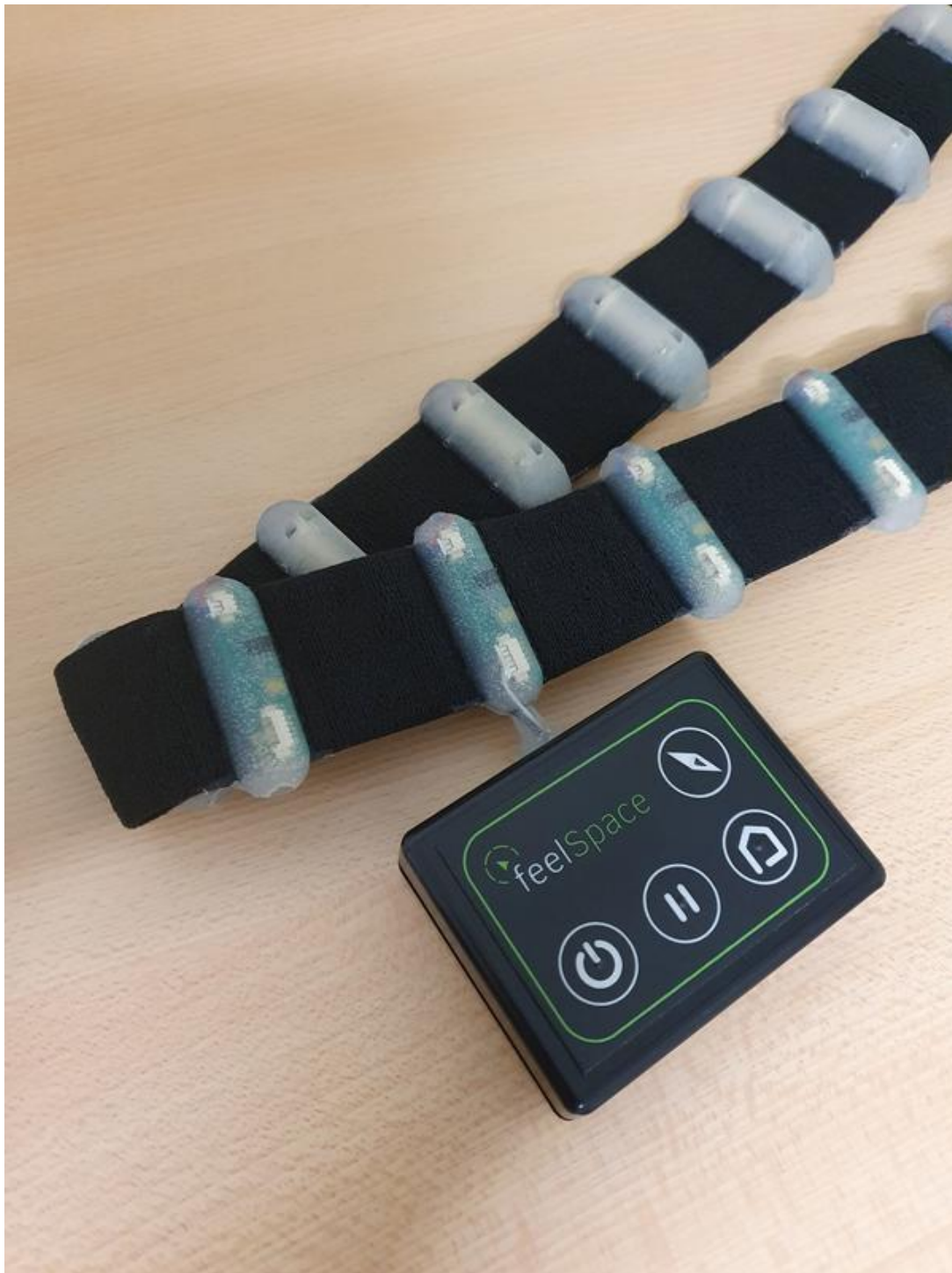
Per Ultraschallschweißverfahren hergestellter Demonstrator feelSpace
