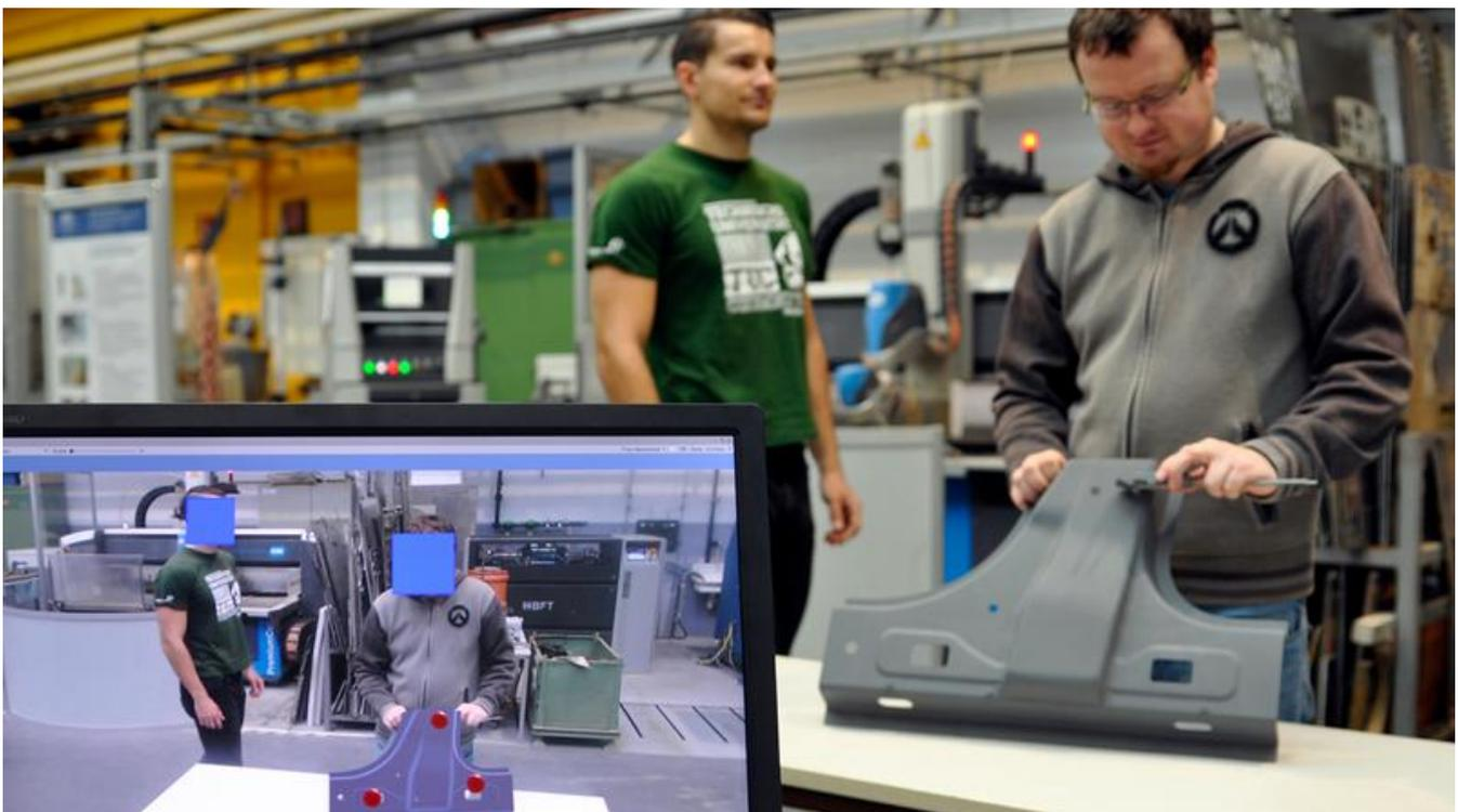
Die neu entwickelte Augmented-Reality-Anwendung anonymisiert automatisch die aufgenommenen Personen und erkennt gleichzeitig dank des Lokalisierungsmoduls wichtige Bauteile.
