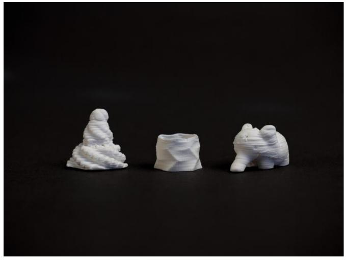
Komplexität und Leichtigkeit: Empa-Forschende haben ein 3D-Druckverfahren für biologisch abbaubares Cellulose-Aerogel entwickelt. Empa
