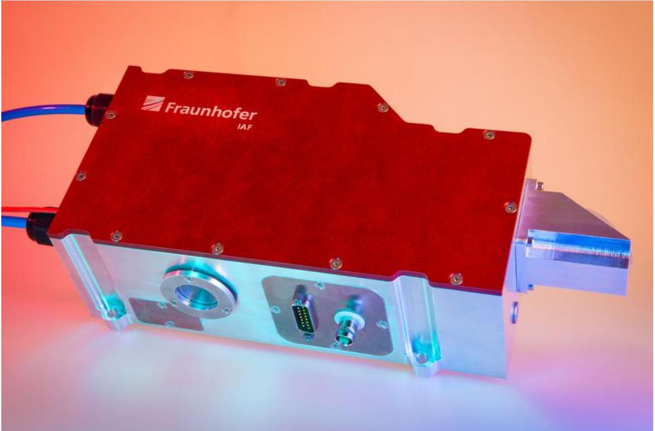
Einmodiges Halbleiter-Scheibenlaser-Modul mit bis zu 2,4 W Ausgangsleistung für den Frequenzbereich zwischen 1,9 und 2,5  $\mu\text{m}$ , entwickelt als Pumpquelle für Quantenfrequenzkonverter
