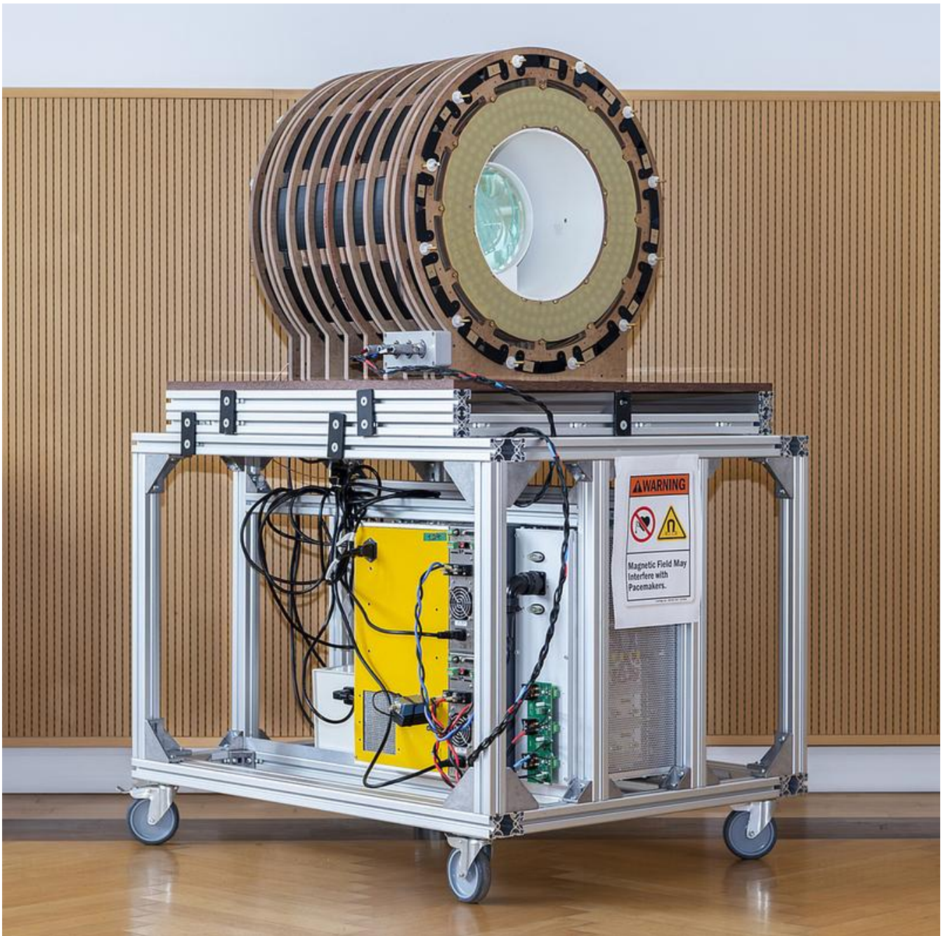
Der Prototyp des neuen kleinen und mobilen MRT-Geräts mit Open-Source-Software und -Hardware der PTB. PTB
