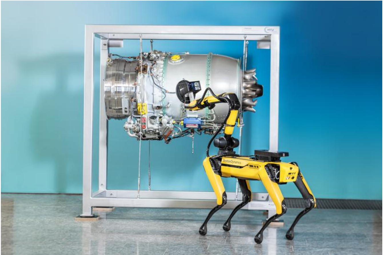
Mithilfe des Sensors vermisst der Roboterhund komplexe Bauteile, hier z.B. eine Turbine (bereitgestellt durch MTU Maintenance). © Fraunhofer IOF
