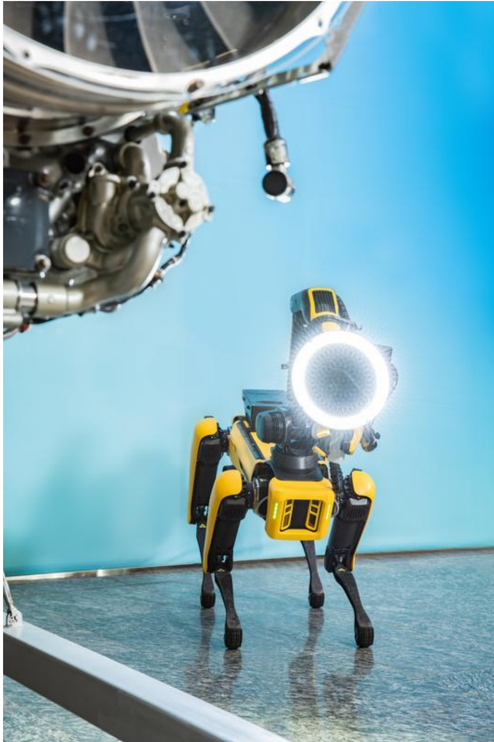
Die Kombination aus Roboterhund und Handscanner macht 3D-Messverfahren noch agiler und flexibler. © Fraunhofer IOF
