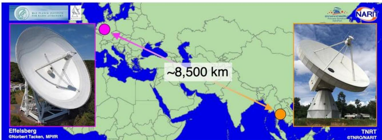
Die in dem VLBI-Experiment verwendeten Radioteleskope: Rechts 40-m TNRT und links das 100-m Effelsberg. Die beiden Radioteleskope sind 8.500 km voneinander entfernt und erreichen die Auflösung eines virtuellen Einzelteleskops von 8.500 km Durchmesser.
