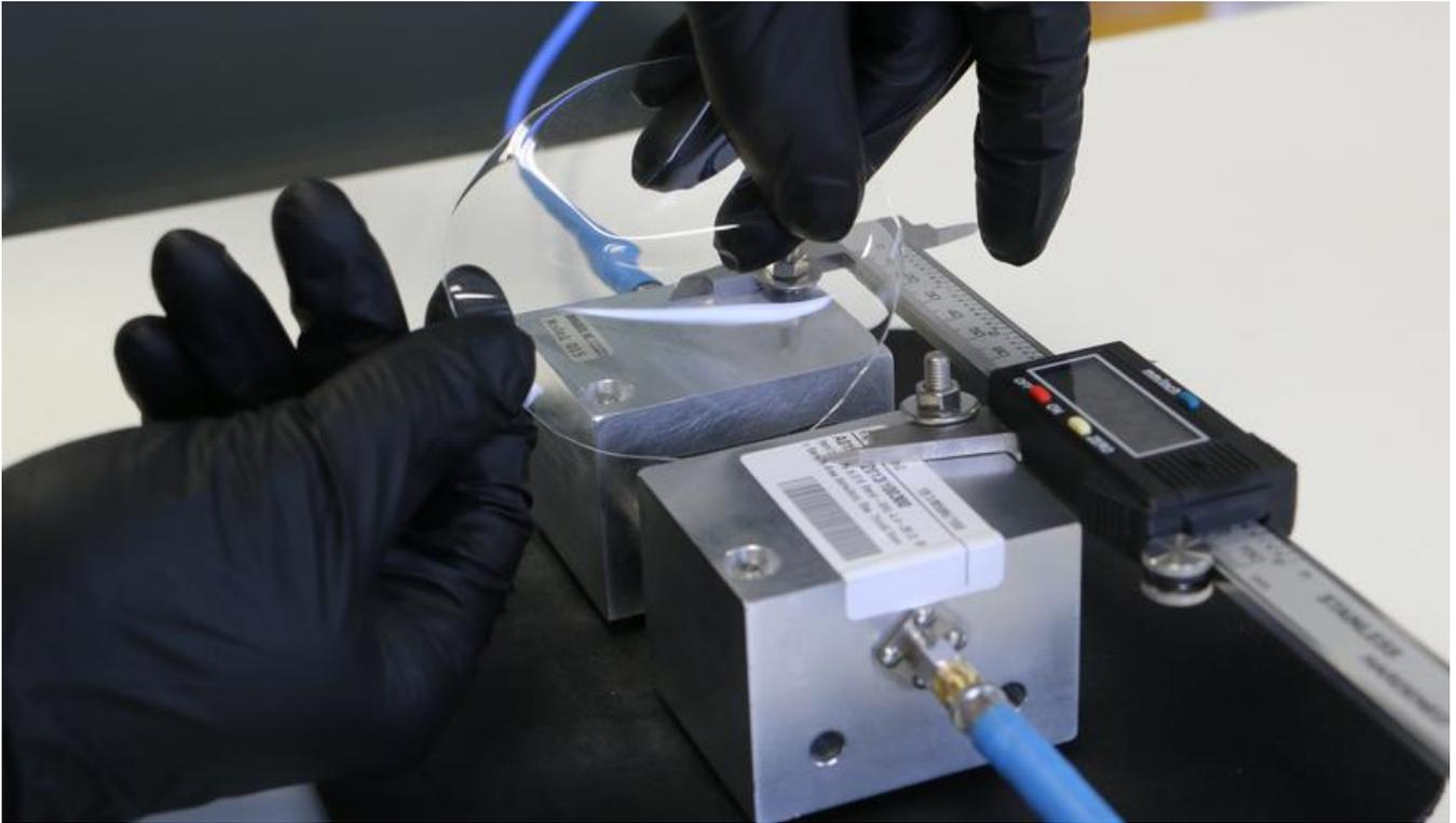
Schmalbandige Messung des Verlustwinkels eines Polymers
