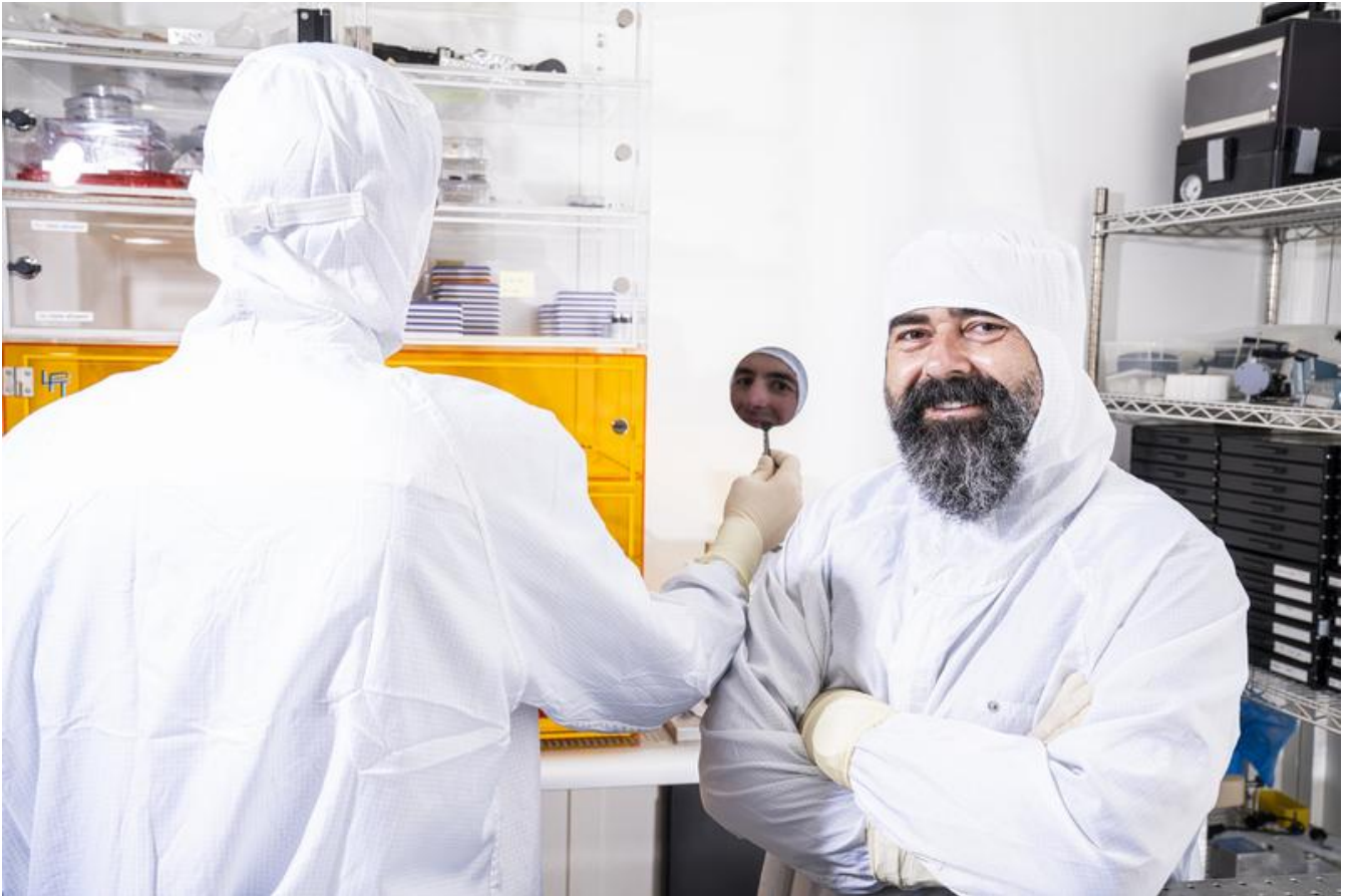
Die Oberfläche eines Silizium-Wafers ist so blank, dass sie ein nahezu perfektes Spiegelbild abbildet, wie hier Iason Giannopoulos (links) und Dimitrios Kazazis demonstrieren. Mahir Dzambegovic Paul Scherrer Institut PSI
