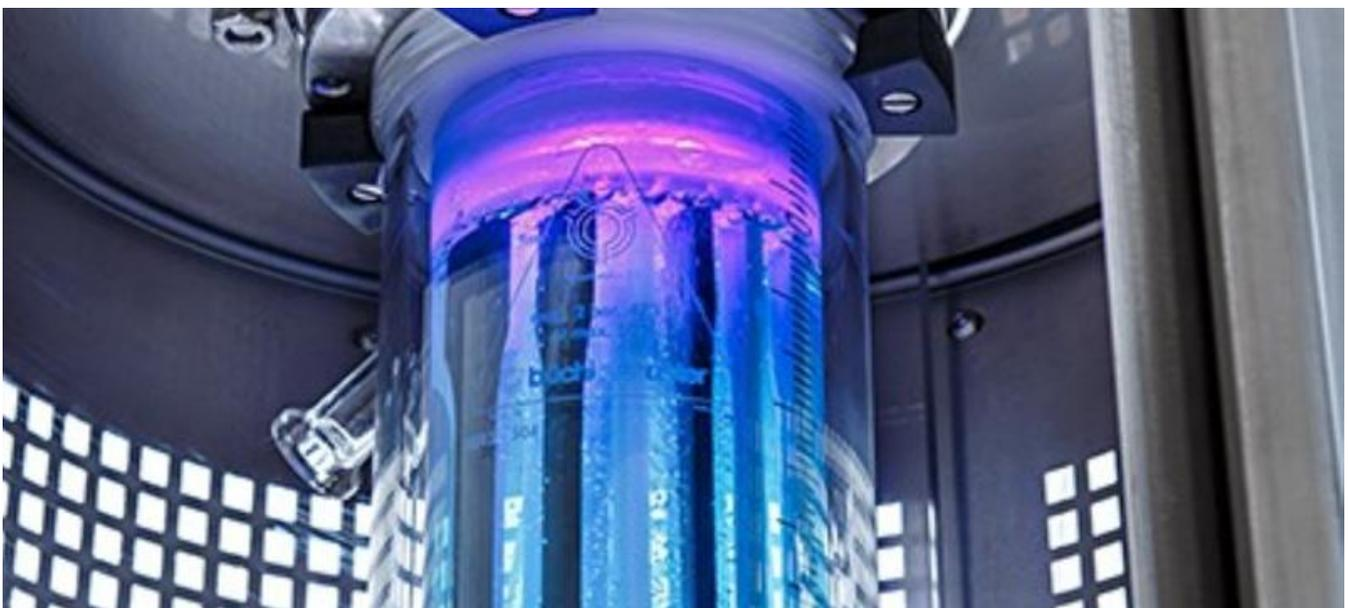
Wasserstofftechnologie sicher und zuverlässig gestalten: Im Fraunhofer LBF werden dazu Elastomere für Elektrolyse und den Einsatz in Brennstoffzellen unter dem Einfluss von Gasen und Flüssigkeiten untersucht.
