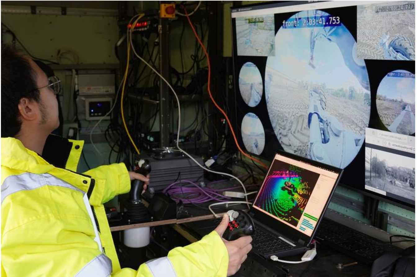
Vom mobilen Leitstand aus wird der Bagger ARTER des DFKI gesteuert. Andrea Fink DFKI
