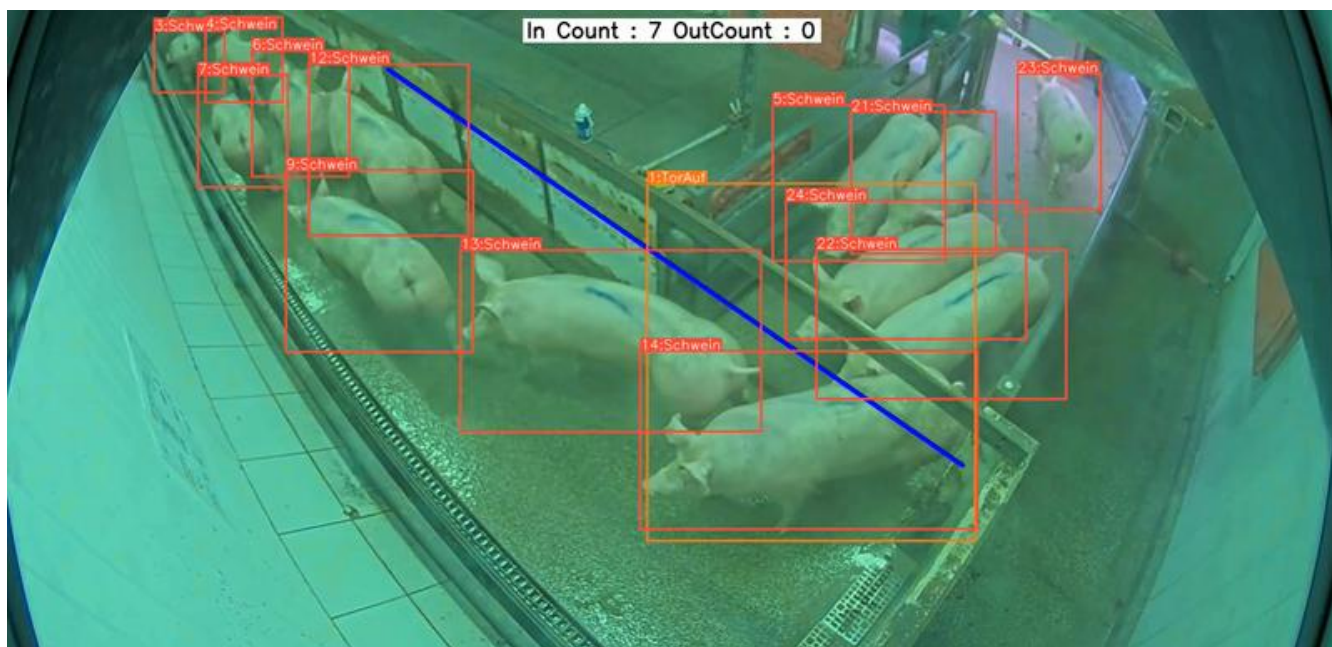
Videobasierte Objekterkennung von Tierschutzverstößen in Echtzeit.
