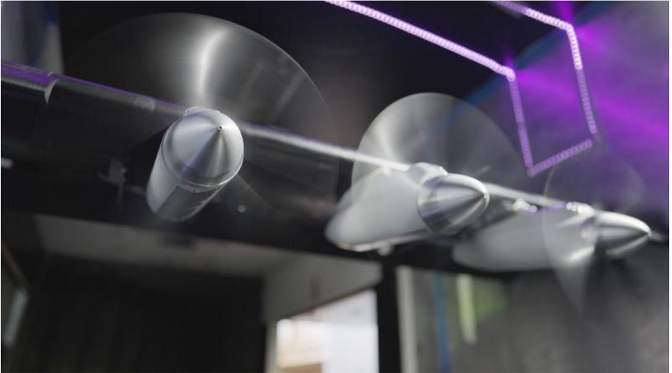
Flugzeuge, an deren Flügel jeweils drei Propeller montiert sind, könnten Kurz- und Mittelstreckenflüge emissionsärmer machen.
