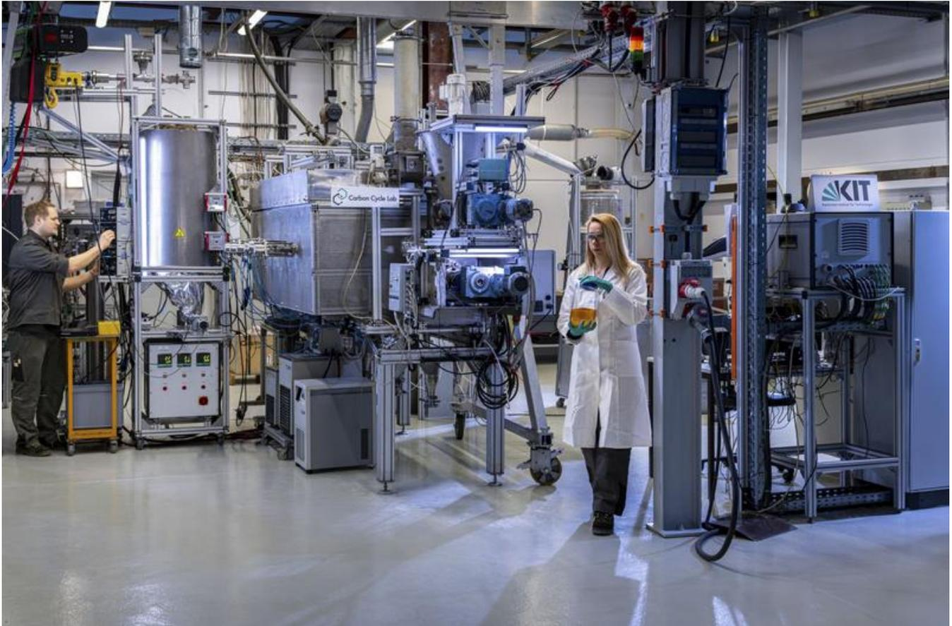
Im Carbon Cycle Lab wird unter anderem das chemische Recycling von Kunststoffabfällen erforscht und in den Pilotmaßstab überführt.
