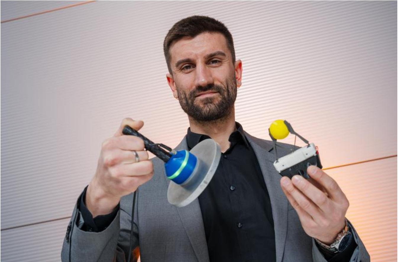
Professor Paul Motzki (Foto) und sein Team zeigen auf der Hannover Messe Prototypen von Robotergriffsystemen, die Werkstücke energielos festhalten und handhaben können, darunter Vakuumgreifer (links, dieser hält eine Stahlplatte) und Zangengreifer (r.).
