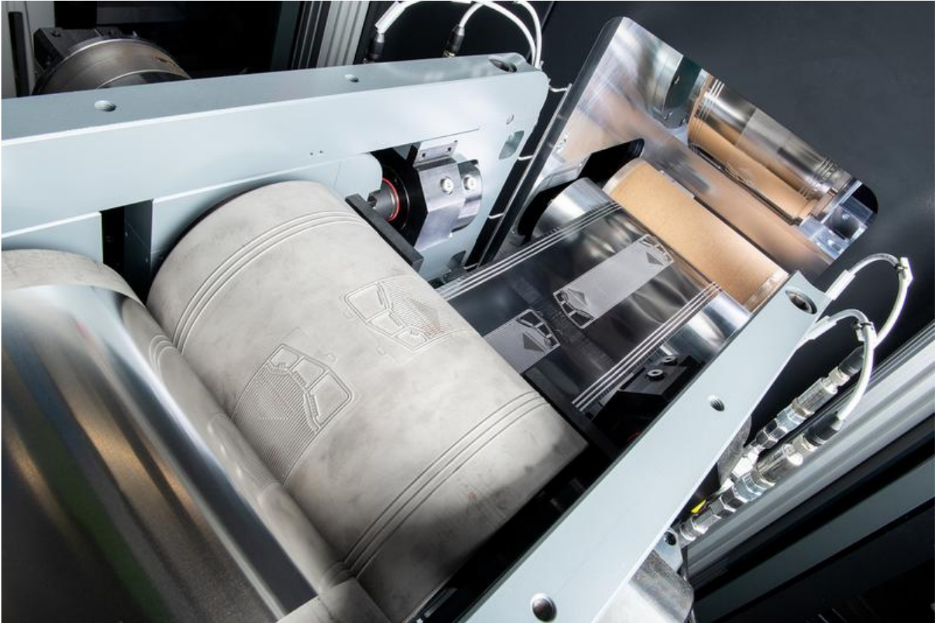
Kontinuierliches Walzprägen zur Produktion von Bipolarplatten Quelle: Fraunhofer IPT
