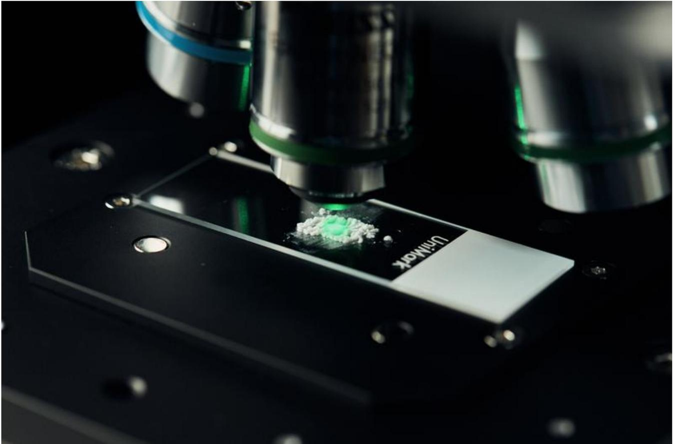
Das Raman-Mikroskop arbeitet mit Laserlicht, wodurch es die Analyse von Molekülen und deren strukturellen Eigenschaften ermöglicht.
